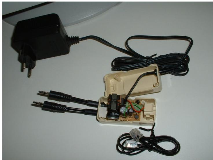
Alternativ kann die Schaltung auch ins Gehäuse einer DECT-Basisstation eingebaut werden. Ältere Geräte haben oft eine doppelte Stromversorgung, so daß die Kontakte fürs Batterieladen galvanisch von der eigentlichen DECT-Schaltung getrennt sind. Bei solchen
